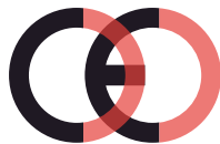
Falsche CE-Kennzeichnung (zu dicht)
